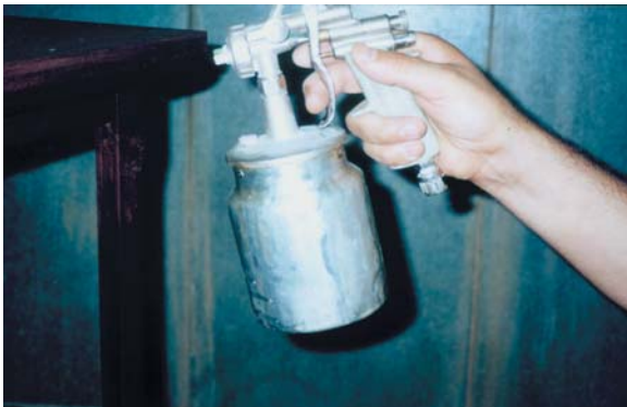
Εικόνα 4.4 Το υπόστρωμα εφαρμόζεται με πιστόλι βαφής και ακολουθεί η τελική επικάλυψη με βερνίκι ή λάκα.
