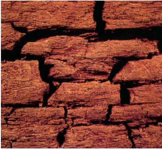
Εικόνα 2.1 Προσβολή ξύλου από διάφορα είδη μυκήτων.
