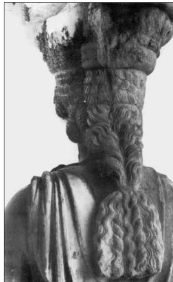
Εικόνα 2.3 Όξινη προσβολή και γυψοποίηση Καρυάτιδας.
