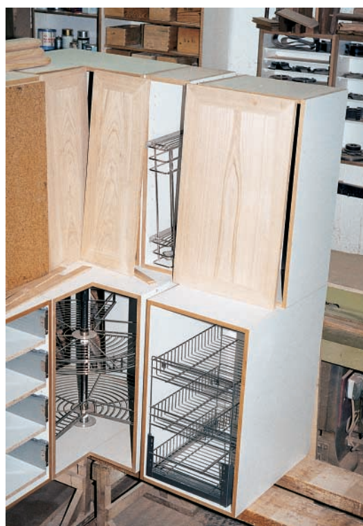
Εικόνα 6.13 Περιστρεφόμενο ράφι και βαγονέτο κατά τη φάση κατασκευής στο εργαστήριο
