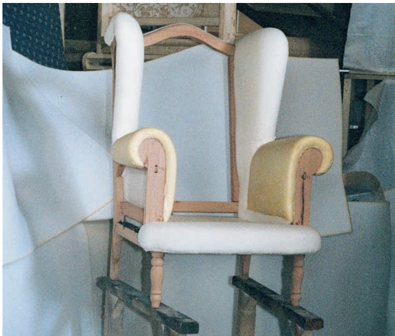
Εικόνα 5.15 Γεμίσματα σκελετού με διογκωμένη πολυουρεθάνη
