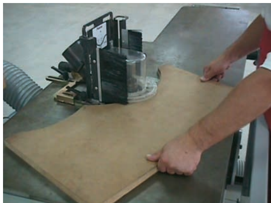
Εικ. 8.9 Μορφοποίηση καμπύλων επιφανειών με τη βοήθεια οδηγού δακτυλίου σε σβούρα.
