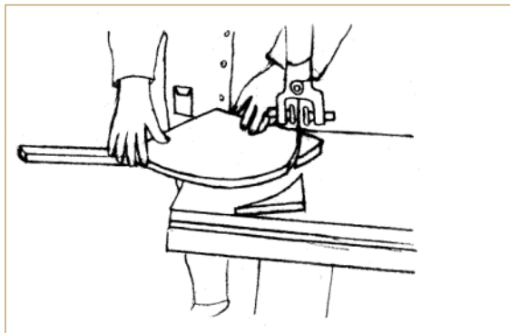
Σχ. 3.13 Κατασκευή κυκλικών επιφανειών με χρήση καλουπιού σε ταινιοπρίονο.
