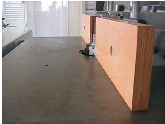
Εικ. 8.6 Ευθυγράμμιση και ρύθμιση των οδηγών.
