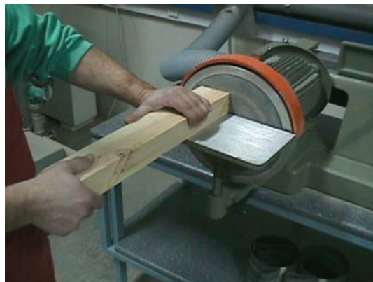
Εικ. 14.6 Λείανση ξύλου σε τριβείο δίσκου.
