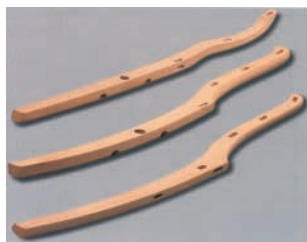
Εικ. 11.1 Στοιχεία επίπλων που κατεργάστηκαν με αυτόματο μορσοτρίπανο.
