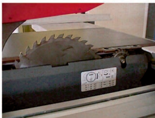
Εικ. 4.5 Δισκοπρίονο τεμαχισμού ξυλοπλακών με επιπλέον δίσκο πρόκοψης.
