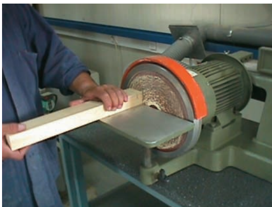
Εικ. 1.9 Λείανση ξύλου σε τριβείο δίσκου.
