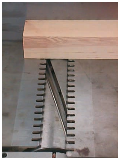
Εικ. 6.2 Κεφαλή πλάνισης με ελικοειδή μαχαίρια.
