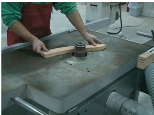
Εικ. 14.5 Λείανση ξύλου σε τριβείο κυλίνδρου.
