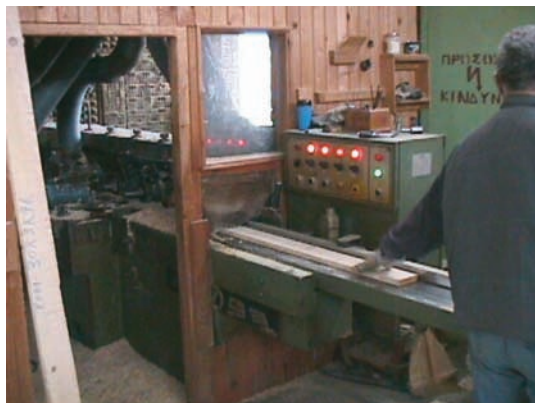
Εικ. 16.5 Τροφοδοσία ραμποτέζας με πριστή ξυλεία.
