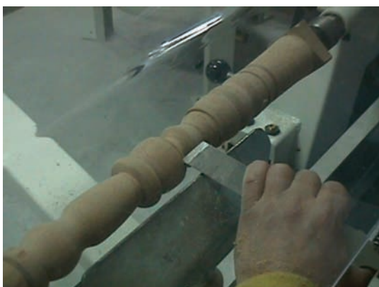
Εικ. 10.4 Δημιουργία μορφών με σκαρπέλο.
