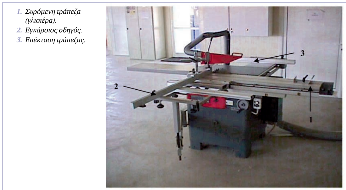
Εικ. 4.4 Δισκοπρίονο τεμαχισμού ξυλοπλακών.
