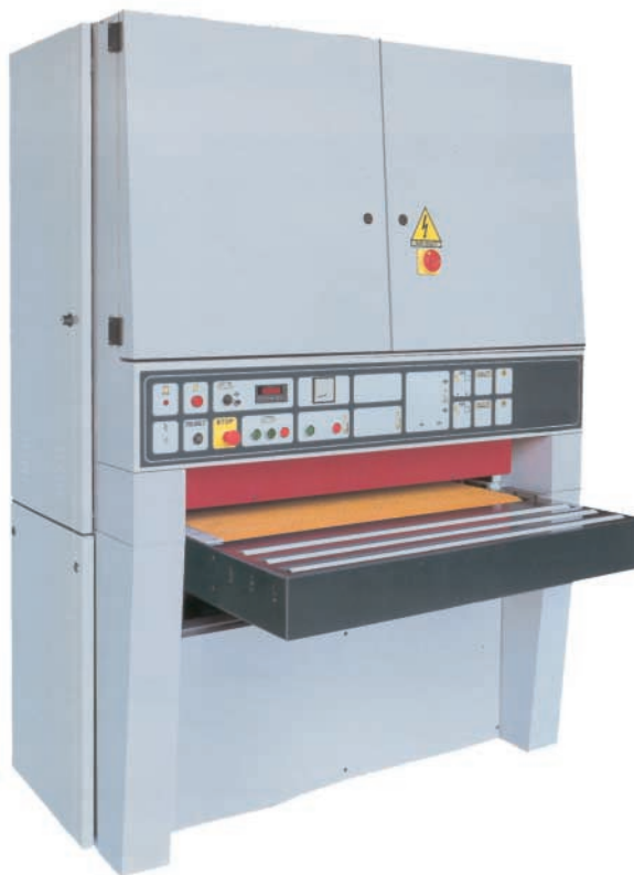
Εικ. 14.7 Τριβείο με πλατιά ταινία λείανσης.
