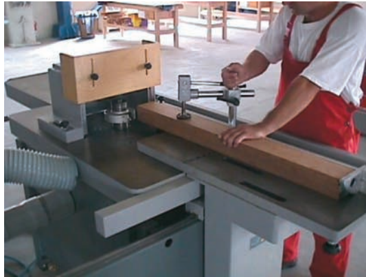
Εικ. 8.8 Εγκάρσια κατεργασία στη σβούρα.
