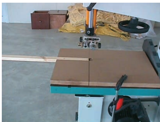
Εικ. 3.7 Τοποθέτηση της ιδιοσκευής στην τράπεζα εργασίας.
