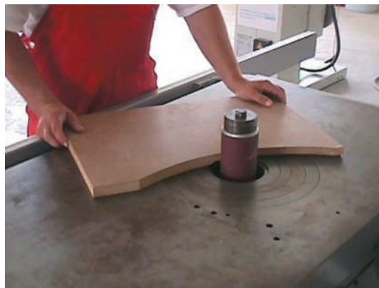
Εικ. 8.10 Λείανση καμπύλων επιφανειών με τριβείο κυλίνδρου τοποθετημένο σε άξονα της σβούρας.
