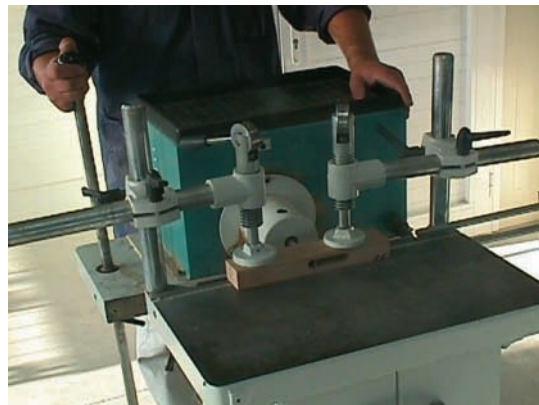
Εικ. 1.6 Διάνοιξη τρύπας σε μορσοτρύπανο.
