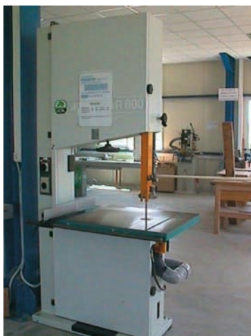
Εικ. 3.4 Ταινιοπρίονο επανάπρισης μικρού βάρους επιπλοποιείων, κτλ.
