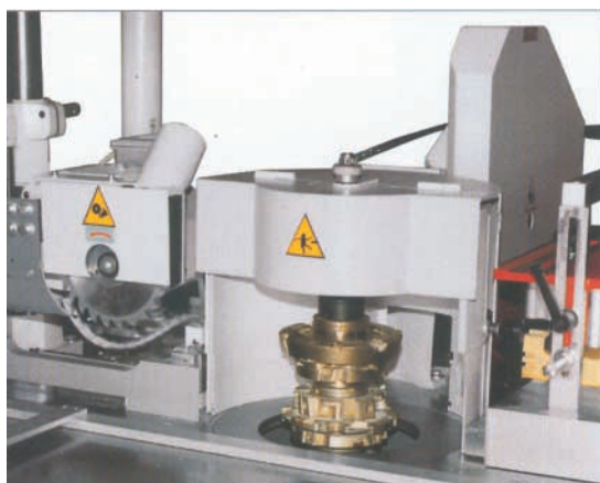
Εικ. 16.9 Πολλαπλή κεφαλή προφίλ και δισκοπρίνο.
