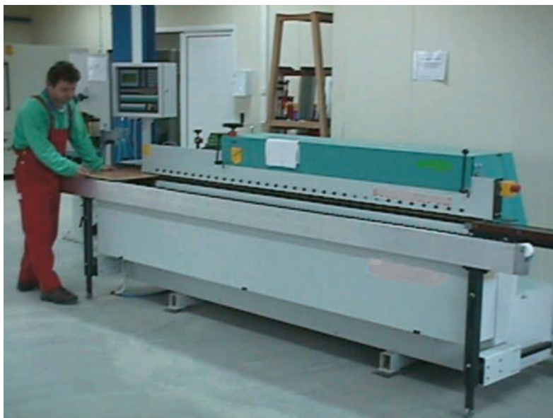
Εικ. 13.7 Τοποθέτηση ξυλοπλάκας στη συγκολλητική περιθωρίων.
