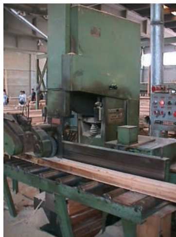
Εικ. 3.3 Ταινιοπρίονο επανάπρισης μεγάλου βάρους.
