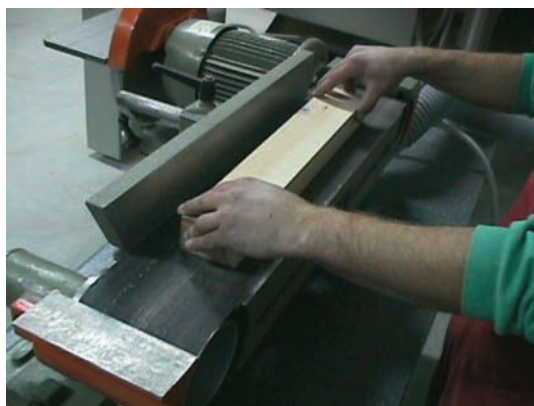
Εικ. 14.4 Λείανση ξύλου σε τριβείο ταινίας.
