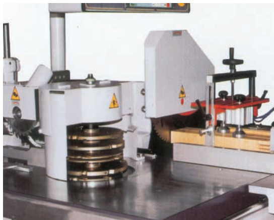
Εικ. 16.7 Πρίση εγκάρσιας επιφάνειας ξυλοτεμαχίου.
