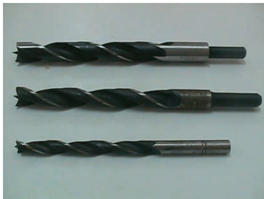
Εικ. 7.1 Τρυπάνια με ελικοειδείς αυλακώσεις.
