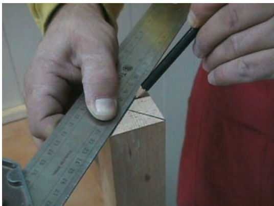
Εικ. 10.2 Εύρεση κέντρου εγκάρσιας επιφάνειας.
