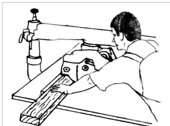
Σχ. 4.9 Πρίση κάθετα στις ίνες του ξύλου.
