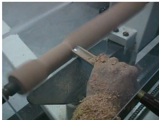
Εικ. 10.3 Τόνρευση ξύλου με καμπύλο σκαρπέλο.
