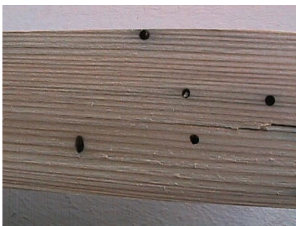
Εικ. 4.5 Εμφάνιση τρυπών σε επιφάνεια ξύλου πεύκης (ξυλοφάγα έντομα)
