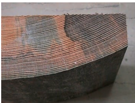
Εικ. 4.1 Εμφάνιση κυάνωσης σε εγκάρσια τομή πεύκου
