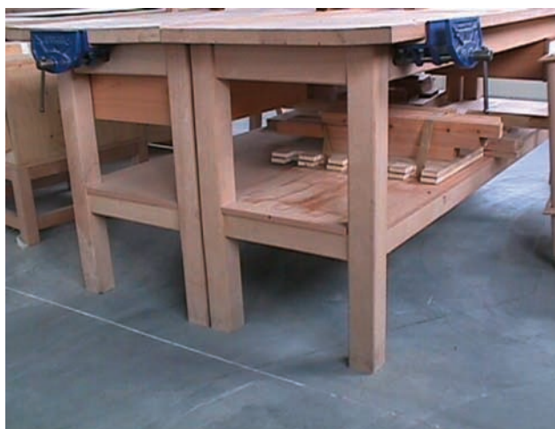
Εικ. 2.8 Στα πόδια του πάγκου εργασίας αναπτύσσονται τάσεις αξονικής θλίψης
