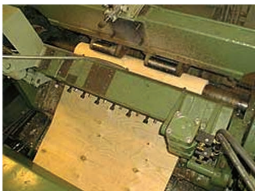
Εικ. 10.1 Το ξυλόφυλλο καθώς εξέρχεται από τη μηχανή εκτύλιξης
