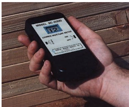
Εικ. 6.3 Εκτίμηση της υγρασίας ξύλου με χρήση ηλεκτρικού υγρόμετρου
