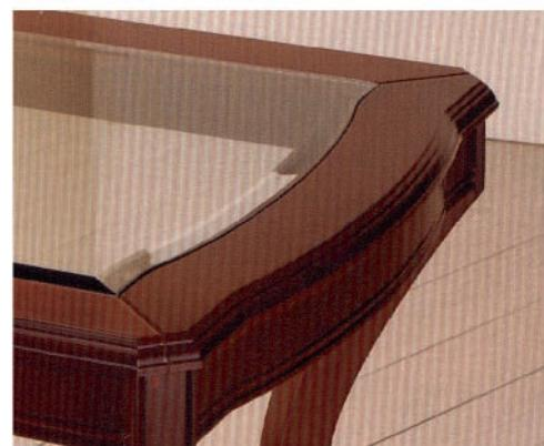
**Εικ. 4.15.** Πλαίσιο τραπεζιού με φαλτσογωνιά και καβίλιες.
