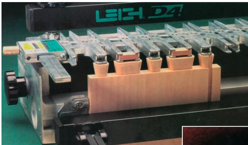
**Εικ. 4.40.** Δοντιέρα (μεταλλικός οδηγός) για κατασκευή δοντιών.
