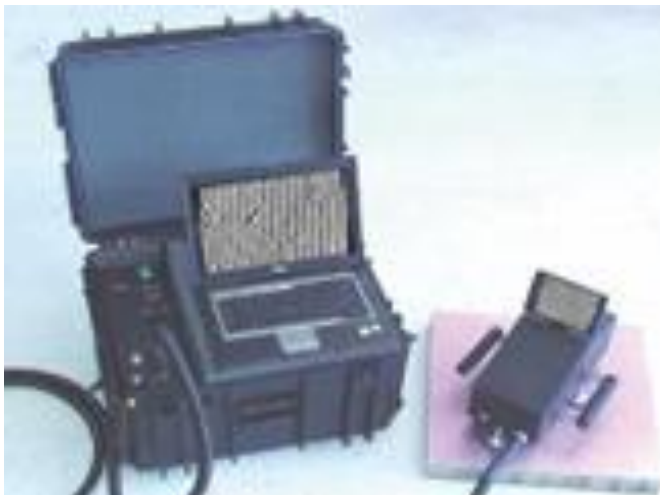
Συσκευή μέτρησης προτύπων διάτμησης με συμβολομετρία (Portable Thermal Shearography)
