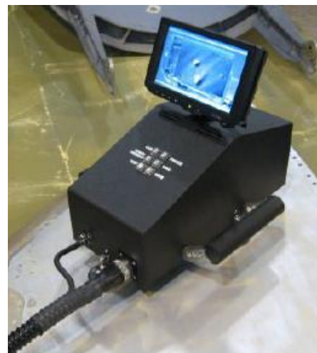
Συσκευή μέτρησης προτύπων διάτμησης με συμβολομετρία (Portable Thermal Shearography)
